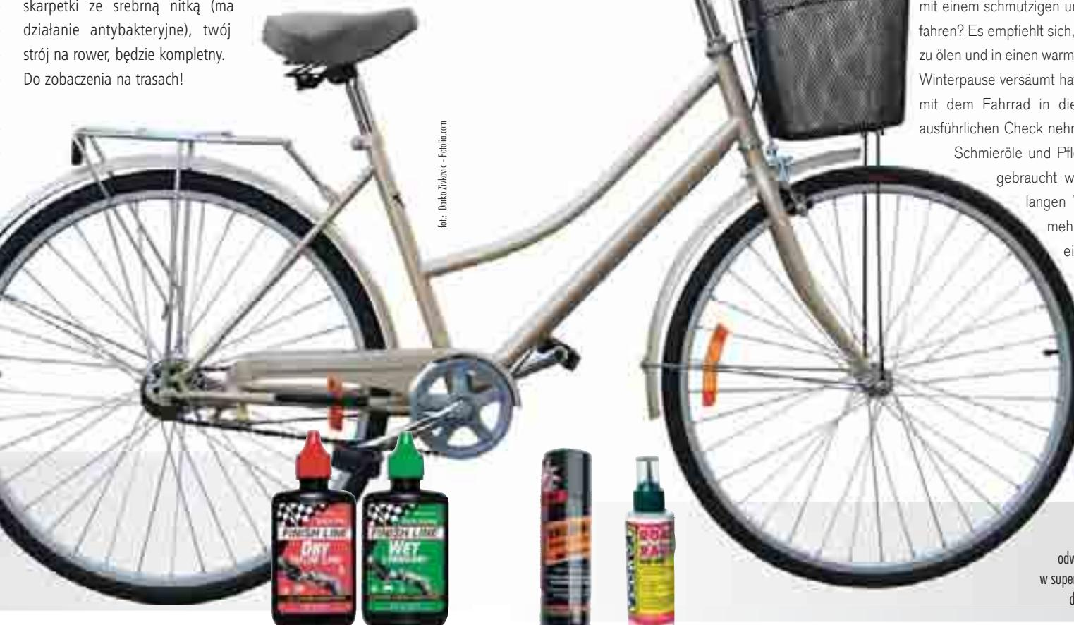
też cały rower umyć ciepłą wodą z mydłem. Suchy łańcuch należy potraktować olejem, np. syntetycznym z domieszką teflonu, który dobrze czyści, smaruje i zapobiega przywieraniu brudu. Na rynku są dostępne produkty zarówno na suche, jak i deszczowe dni oraz uniwersalne.
